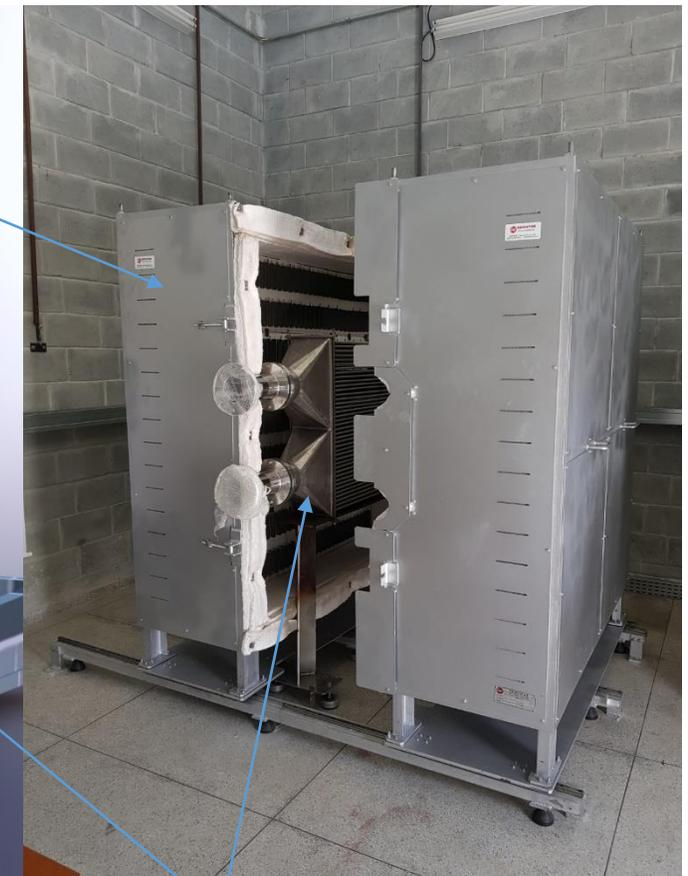
Trocador de calor da fonte quente do ciclo.
