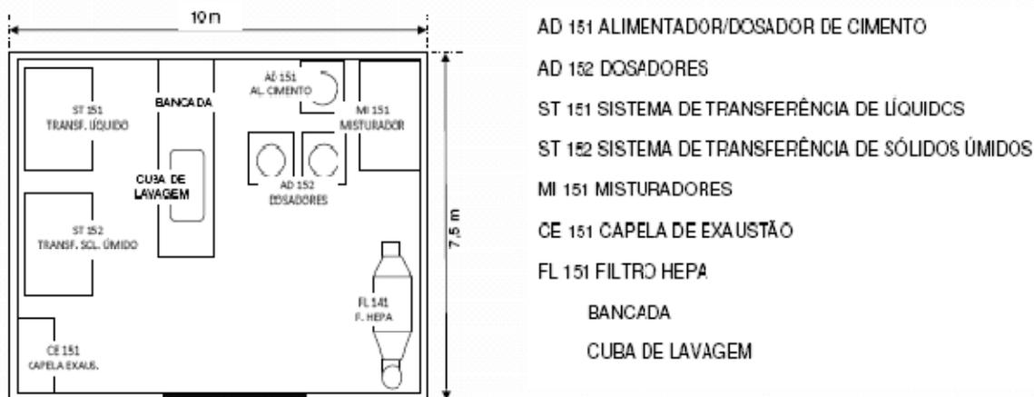
Figura 47 – Croqui da Unidade de Imobilização e Encapsulamento.
