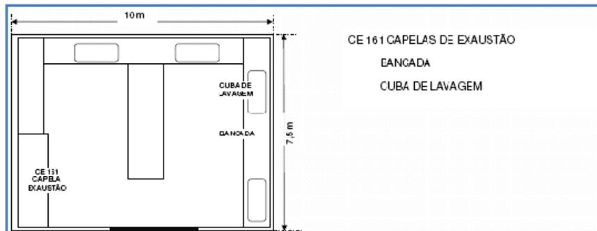
Figura 48 – Croqui da Unidade de Tratamento de Rejeitos Líquidos e Sólidos Úmidos.
