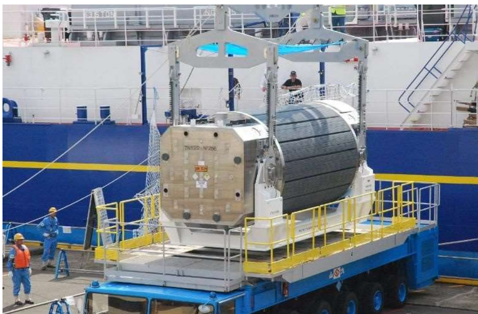
Cilindro contendo combustível MOX, uma mistura de plutônio e urânio, chega à usina nuclear de Fukui, Japão
