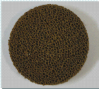
FIG. 1(a). Fly ash filter.
